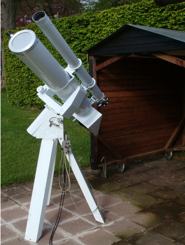
Bruno Nolf - 08.05.2015 15cm f8 skywatcher refractor baader herschel - 2.5x TV powermate olympus e520
